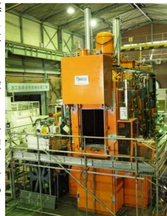
図1 金型用高機能熱処理炉の外観
