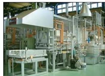
スペリア式バッチ型ガス浸炭窒化炉
