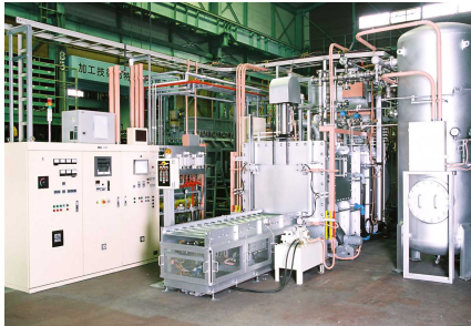
スベリア式バッチ型ガス軟窒化炉 型式：BBN-400 400kg処理
