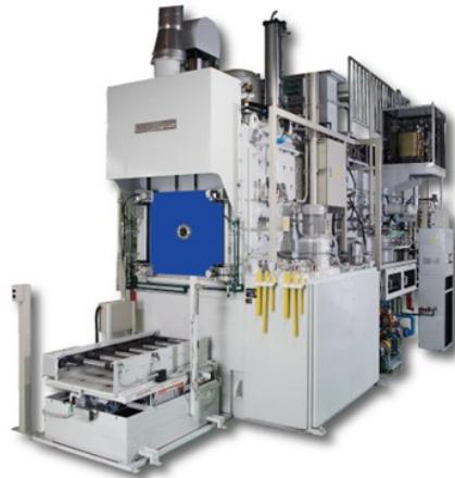
独自に開発した2つのセンサにより、真空浸炭炉雰囲気の適性制御実現！
