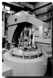
ビット型ガス軟窒化炉
