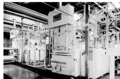
スベリア式バッチ型ガス軟窒化炉
