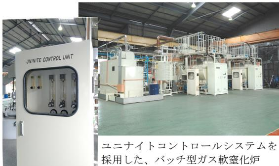
ユニナイトコントロールシステムを採用した、バッチ型ガス軟窒化炉
