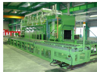
スベリア式連続光輝焼炭炉
