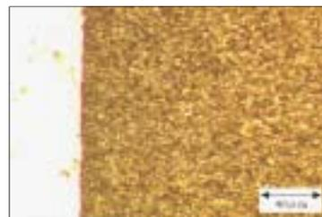
図1 1)の条件による高温浸炭処理組織
