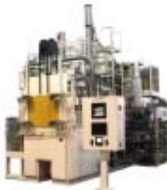
真空浸炭炉装置 200kgタイプ
