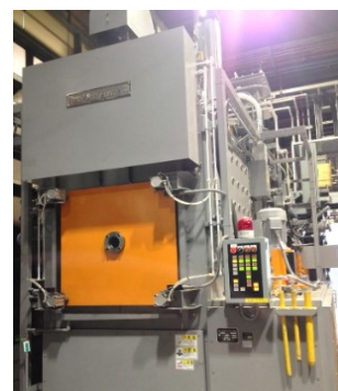
図1 雰囲気制御付 真空浸炭炉NEOVIA
