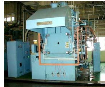
独自に開発した2つのセンサにより、真空浸炭炉雰囲気の適性制御実現!
